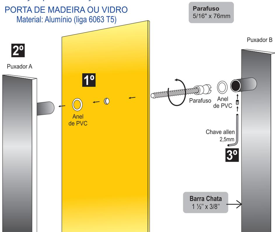
**1º** Atravesse o parafuso através da porta e passe o anel de PVC.
